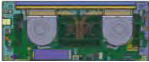
本体内部の熱を効率的に排出する 高効率の冷却ファン
