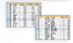
作成データから、各部屋ごとの面積や長さ、属性データ、外 壁面積など、見積書作成に必要なデータをExcel/CSV形 式で出力できます。建具などの明細利用や内装材(床・壁など) の数量拾い出しに役立て、見積書作成にかける時間を大幅 に短縮します。
