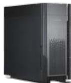
オプションで水冷キット装着も可能な高性能ワークステーション。DW GPU 4枚または TW GPU 2枚まで搭載可能
