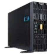
デュアルスロットタイプのGPUを最大4基搭載可能。且つIPMI準拠でサーバークラスの遠隔管理が可能なプロフェッショナルワークステーション
